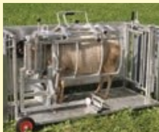
In de hoogte verstelbare draaikorf met uitschuifbare steunders voor aanpassing aan de grootte van het dier
