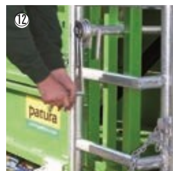
⑫ Terugslagvrije achterpootlier voor het gemakkelijk opheffen van de achterpoten
