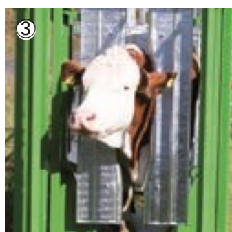
③ Het halsvastzetframe zet dieren van alle groottes vast.
