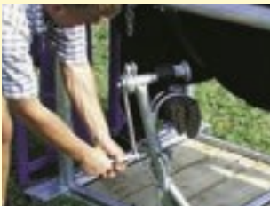
Comfortabele voorpootlier voor het gemakkelijk opheffen van de voorpoten
