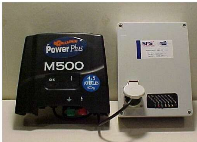
foto: SSO systeem aangesloten op een schrikdraadapparaat
