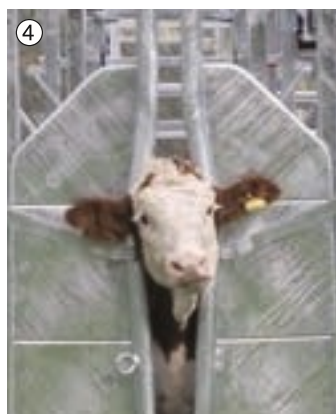
4 Halsvastzetframe voor het vastzetten van iedere diergrootte.
