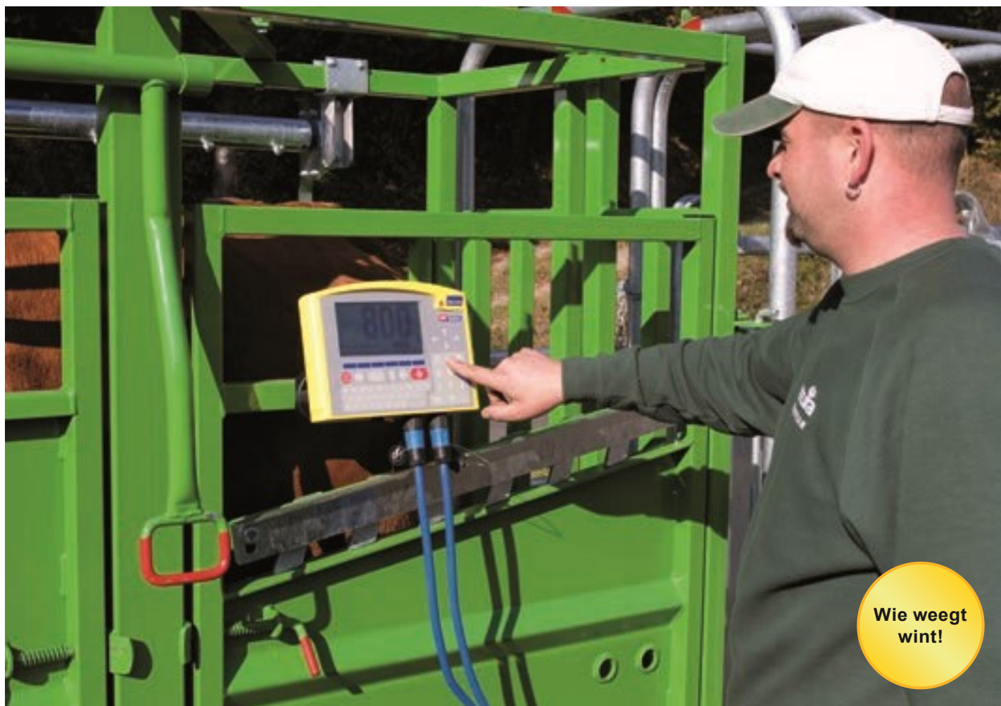
De PATURA behandelbox met elektronische Tru-Test weegschaal, bestaande uit weegcomputer met digitale display en 2 weegbalken (Zie hoofdstuk weegtechniek)
